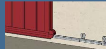
Réglette support en partie basse pour porte-fenêtre
